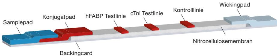
Auf den Bereichen der NC Membran (cTnI) und (hFABP) wurde jeweils Fängerantikörper gegen den entsprechenden Biomarker immobilisiert. Die spezifischen Signale bilden sich aus, wenn ein Antikörper auf der Membran ein Antigen fängt, das seinerseits durch Goldkolloid markiert wurde. Man spricht bei diesem Aufbau, bei dem ein Antigen von zwei Antikörpern gefasst wird, von einem Sandwich-Immunoassay.
