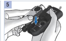
Legen Sie die Testkassette in das Messgerät. Drücken Sie den Kassettenschubdeckel zu. Schließen Sie den Spitzenschutz.
