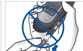
Entfernen Sie die Lanzettentrommel **nicht**, bevor alle 6 Lanzetten aufgebraucht sind.
