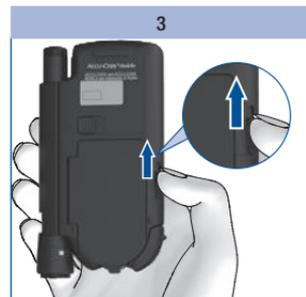
Schieben Sie den Entriegelungsknopf für den Kassettenfachdeckel nach oben.
