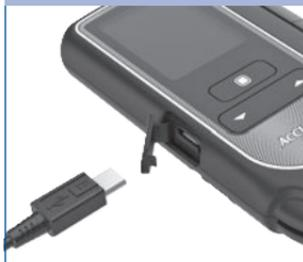
Stecken Sie den Micro-B-Stecker des USB-Kabels in die USB-Schnittstelle des Messgeräts.
