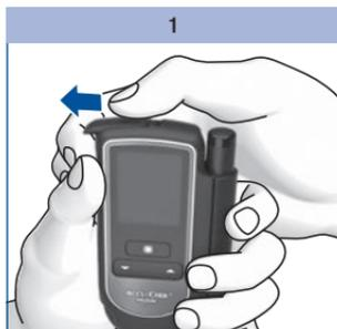
Schieben Sie den Batteriefachdeckel bis zum Anschlag in Pfeilrichtung auf.
