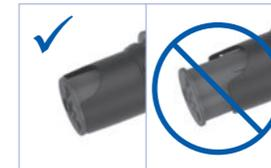
Die Lanzettentrommel ist richtig eingesetzt, wenn sie vollständig in der Stechhilfe steckt und nur noch der überstehende Rand vorn heraussteht.
