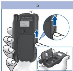
Schieben Sie den Entriegelungsknopf für den Kassettenfachdeckel in Pfeilrichtung nach oben.
