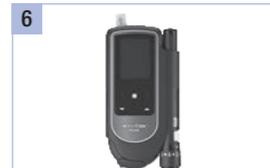
Ziehen Sie die Schutzfolie der Batterien nach hinten aus dem Messgerät. Ziehen Sie die Schutzfolie von der Anzeige ab.
