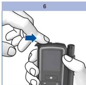
Schieben Sie den Batteriefachdeckel bis zum Anschlag in Pfeilrichtung zu.
